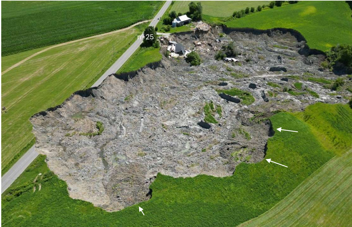
Figure 8 : Vue du glissement de terrain prise par drone le 20 juillet 2025. On peut y voir la résidence n° 25 qui a été emportée dans les heures précédentes, ainsi que des traces de ruptures rotationnelles récentes sur le pourtour de la cicatrice (flèches blanches). (Source : MTMD)
