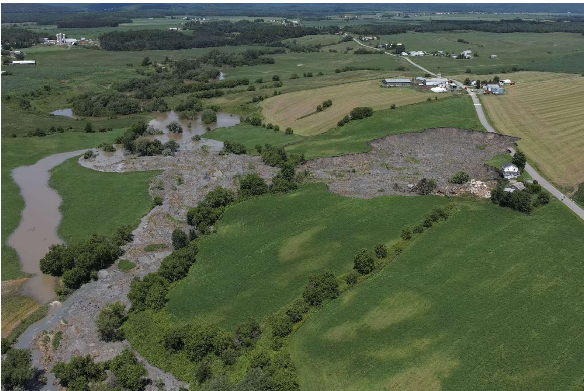
Figure 6 : Vue d'ensemble de la cicatrice et d'une partie des débris obstruant la rivière Blanche le 16 juillet. À noter à gauche le nouveau chenal que la rivière a commencé à emprunter. (Source : MTMD – DJI_20250718131933_0159)
