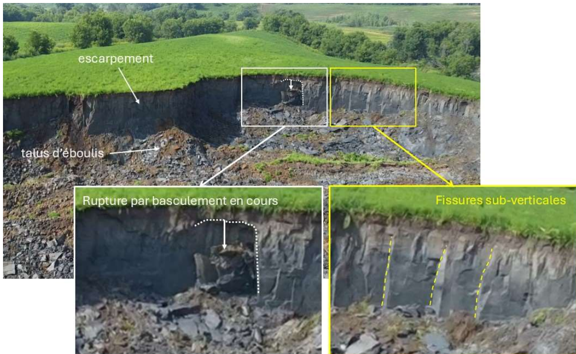
Figure 9 : Photographies prises par drone le 16 juillet 2025, montrant des fissures subverticales au pourtour de la cicatrice, facilitant le développement de ruptures par basculement. (source : MTMD)
