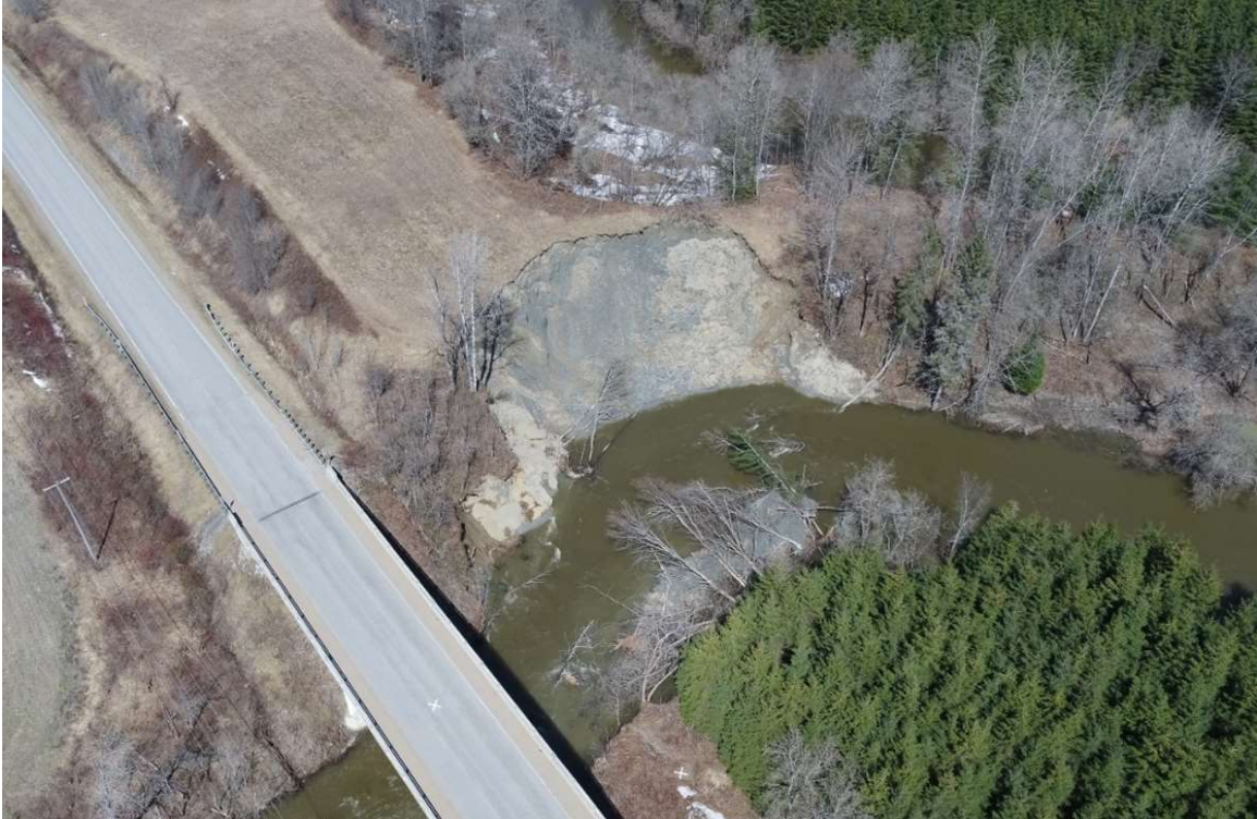
Figure 6 : Vue par drone du glissement d'avril 2022 en bordure de la rivière Noire, près du chemin et du pont du rang Saint-Philippe. (Source : MTMD – DGG)
