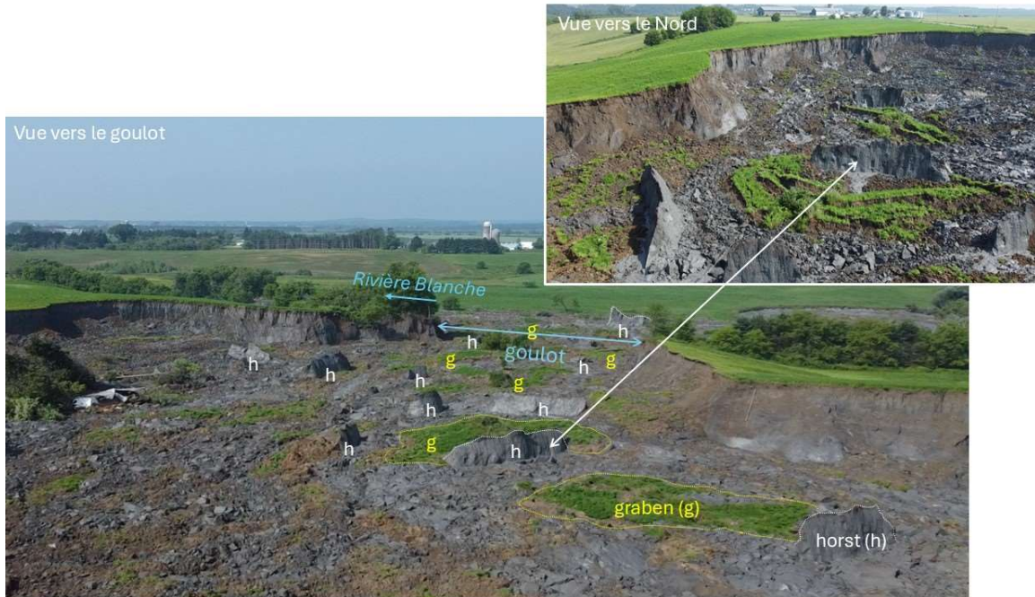
Figure 7 : Vue de horsts(h) et grabens (g) à l'intérieur de la cicatrice du glissement. (Source : MTMD)
